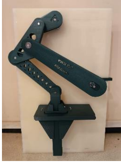
Şekil 6: Modüler mekanizmanın montaj görünümü
