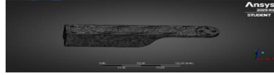
Şekil 4: Kanatta mesh uygulaması
