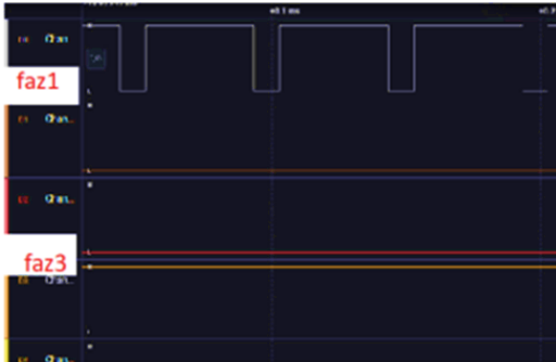
Şekil 2.b: PWM ile sürme anahtarlama sinyali
